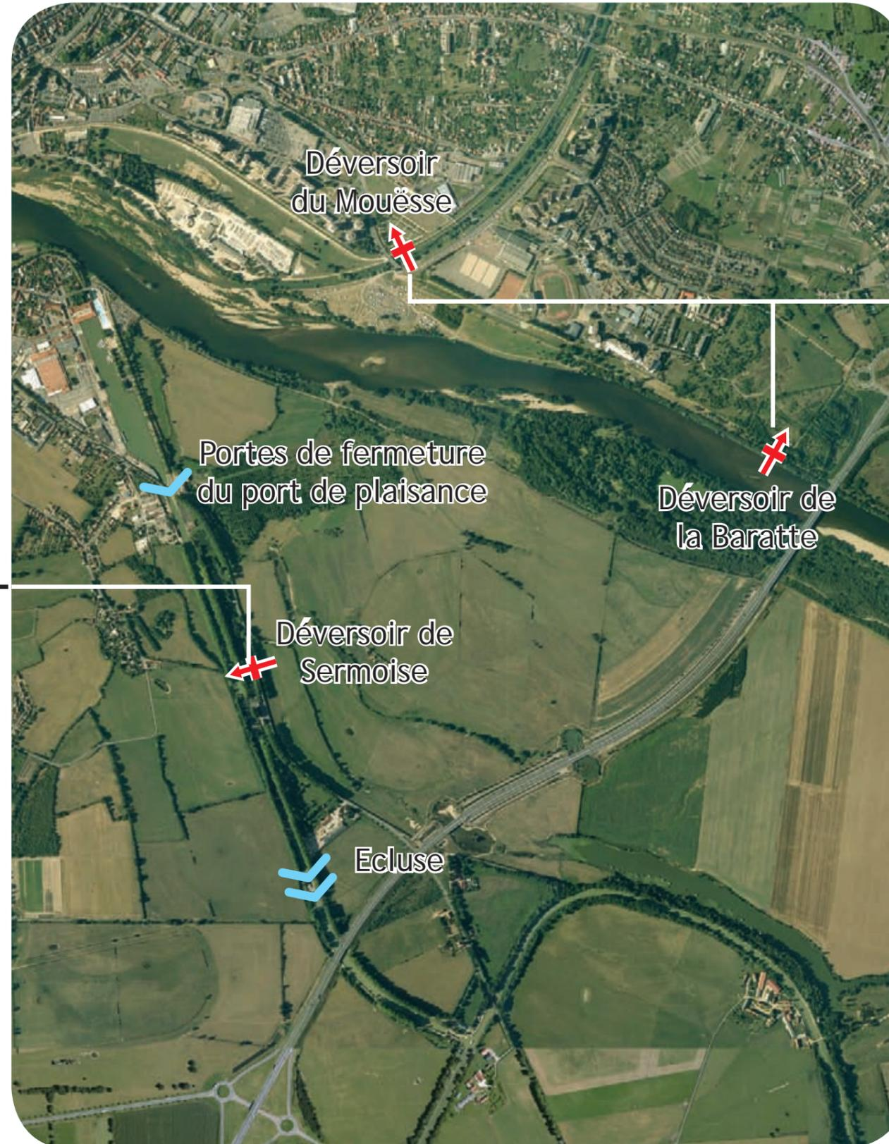
En rive gauche, les levées sont plus fragiles. Pour les fortes crues, une banquette fine et haute tente de limiter les surverses. Le val est lui-même inondé par remous, par les ouvertures du remblai SNCF. Un déversoir de 170 m de large dans la digue de Sermoise serait à prévoir simultanément avec le renforcement de la levée.
